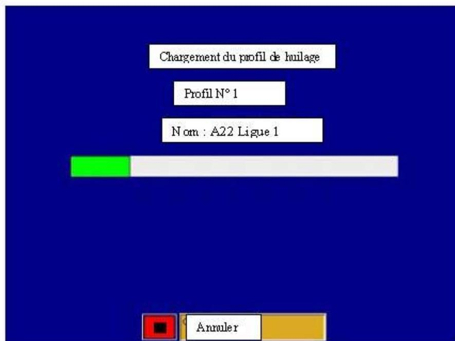
Figure 4-12. Progression du chargement du profil de huilage dans la mémoire de la carte de contrôle.
