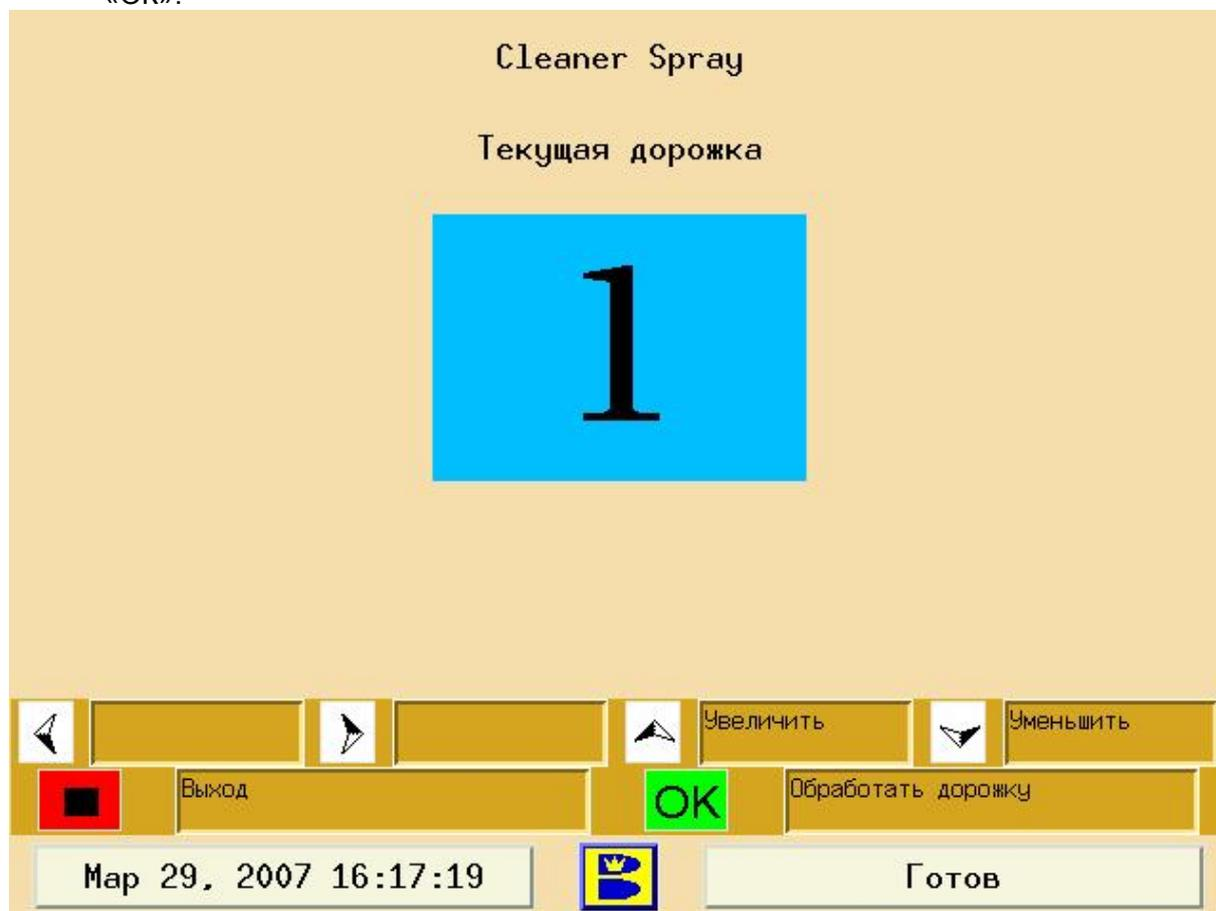
Рисунок 4-30 Экран проверки форсунок
